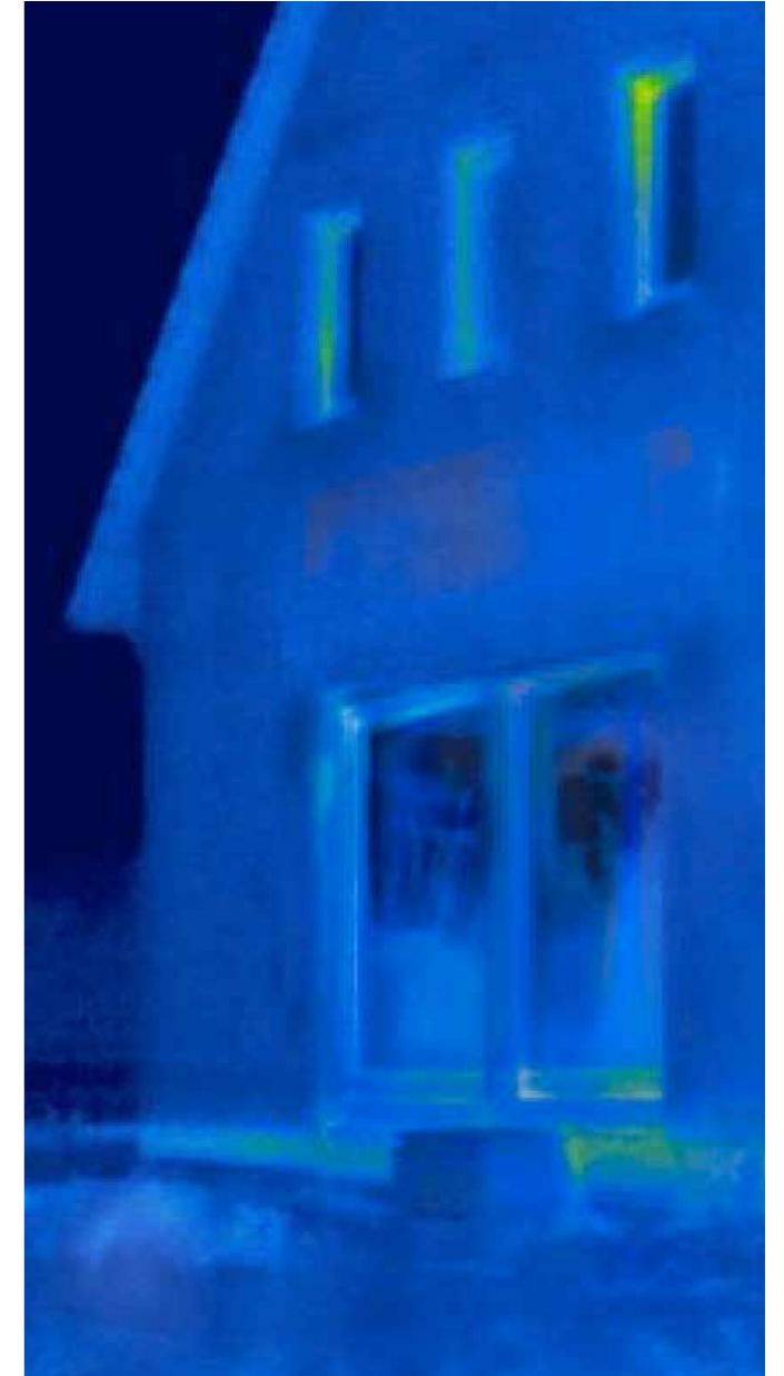
Po renovacijos: dėl stumdomųjų durų „GENEO“ prarandama ženkliai mažiau šilumos.
