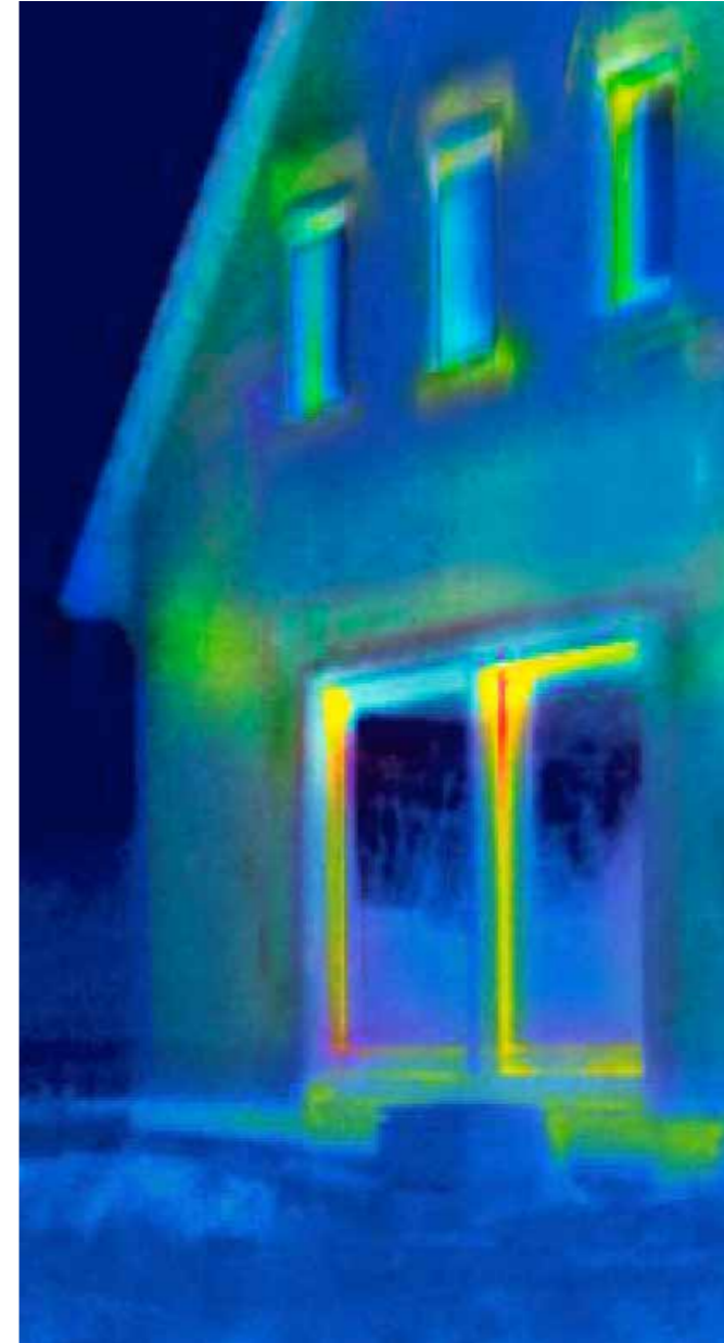
Prieš renovaciją: dideli šilumos nuostoliai paveikslėlyje pavaizduoti raudonai.
